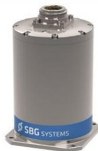
Dans le cadre du projet SSHEAR ce matériel a pour utilité, lors d'un levé bathymétrique réalisé au sondeur multi-faisceaux, de prendre le relais de la position GPS dès lors qu'une perte du signal se produit (exemple : passage sous un ouvrage). Cet appareil est alors capable d'intégrer les mouvements du bateau (accélération et vitesse angulaire) pour estimer son orientation (angles de roulis, de tangage et de cap), sa vitesse linéaire et sa position.
